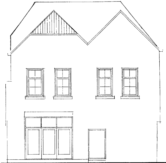
Afb. 8. Opmeting bestaande toestand van de achtergevel in 1983. Het linker huis met het afgewolfde schilddak is het 15de-eeuwse huis. Het rechtergedeelte is in de 19de eeuw ontstaan. Men was voornemens de zakgoot tussen de beide panden te elimineren door tussen de nokken een plat dak te maken (herkomst tekening: Archief van Bouw- en Woningtoezicht gemeente Breda).
