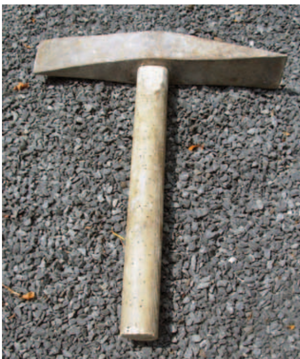
4. De polka. De snede staat loodrecht op de steel van het werktuig (foto Frans Doperé)
