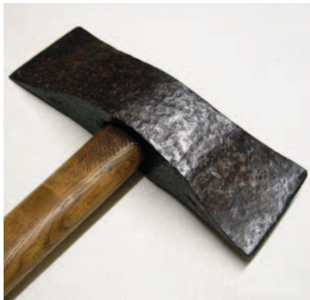
3. De steenbijl of zwaaiivlechte. De snede loopt parallel met de steel van het werktuig (foto Frans Doperé)
