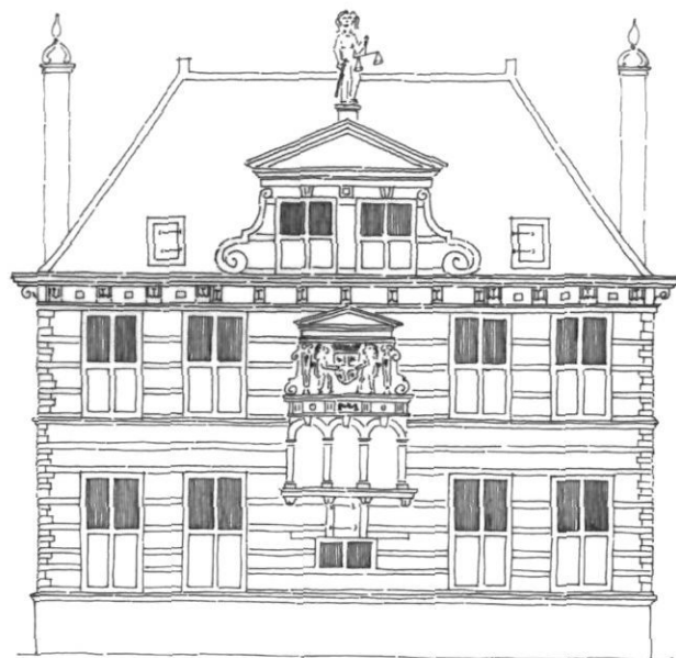
Afb. 5. Rotterdam. Raadhuis, achtergevel aan de Kaasmarkt (1607). Pronkdak met gootlijst en bescheiden siertop. Schoorstenen in de goten. Galerij voor de rechtspraak. Getekend met behulp van plattegronden uit 1781 en oude afbeeldingen (GAR)[schaal 1:±275]
