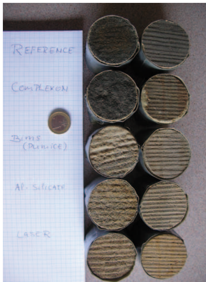
3. Bij het eerste onderzoek naar de mogelijkheden om zandsteen schadevrij te reinigen zijn proefvlakken gemaakt met verschillende reinigingstechnieken. Uit deze proefvlakken zijn kernen geboord voor onderzoek in het laboratorium. De linker kolom toont Bentheimer, de rechter Obernkirchener zandsteen. Van boven naar beneden zijn achtereenvolgens te zien: de niet gereinigde referentie, reiniging met EDTA-pasta, wervelreinigen met bims, wervelreinigen met aluminiumsilicaatglas, en reiniging met laser (foto Timo G. Nijland)
