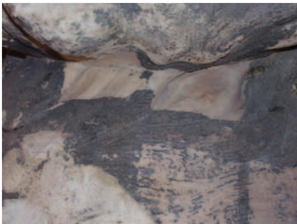
6. Het effect van reiniging op Carrara marmer is onderzocht op een in het verleden verwijderde putto. Grote delen van het marmer zijn bedekt met een zwarte gipskorst. Twee rechthoekige vakjes op het midden van de foto zijn van de gipskorst ontdaan door droog microstralen (foto Timo G. Nijland)
