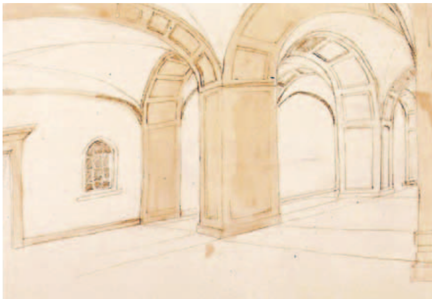
2. Entreerimte aan de Nieuwezijds Voorburgwal. Herkenbaar zijn de in zandsteen uitgevoerde kolommen, pilasters, gordelbogen en gewelfribben langs de wanden. Ook de deur- en vensteromlijstingen en de plinten zijn in zandsteen uitgevoerd (tekening Koningin Wilhelmina, pen in sepia op papier, omstreeks 1953. Stichting Historische Verzamelingen van het Huis Oranje-Nassau, inv. nr. Sch/008)
