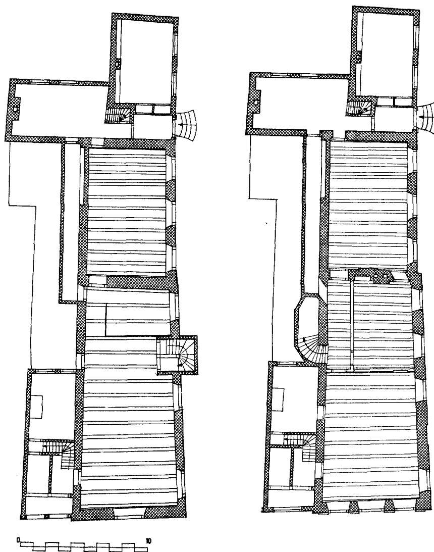
Fig. 5. Stadhuis. Schaal 1 : 300. Links de indeling voor de verbouwing van 1791. Rechts de indeling na de verbouwing van 1791. De opzet van de plattegrond met groot voorstuk en kleinere achterkamer gaat waarschijnlijk terug tot de 14de eeuw. Vermoedelijk werd het buurhuis links in het begin van de 16de eeuw bij het stadhuis getrokken. (Tekening Monumentenzorg)
