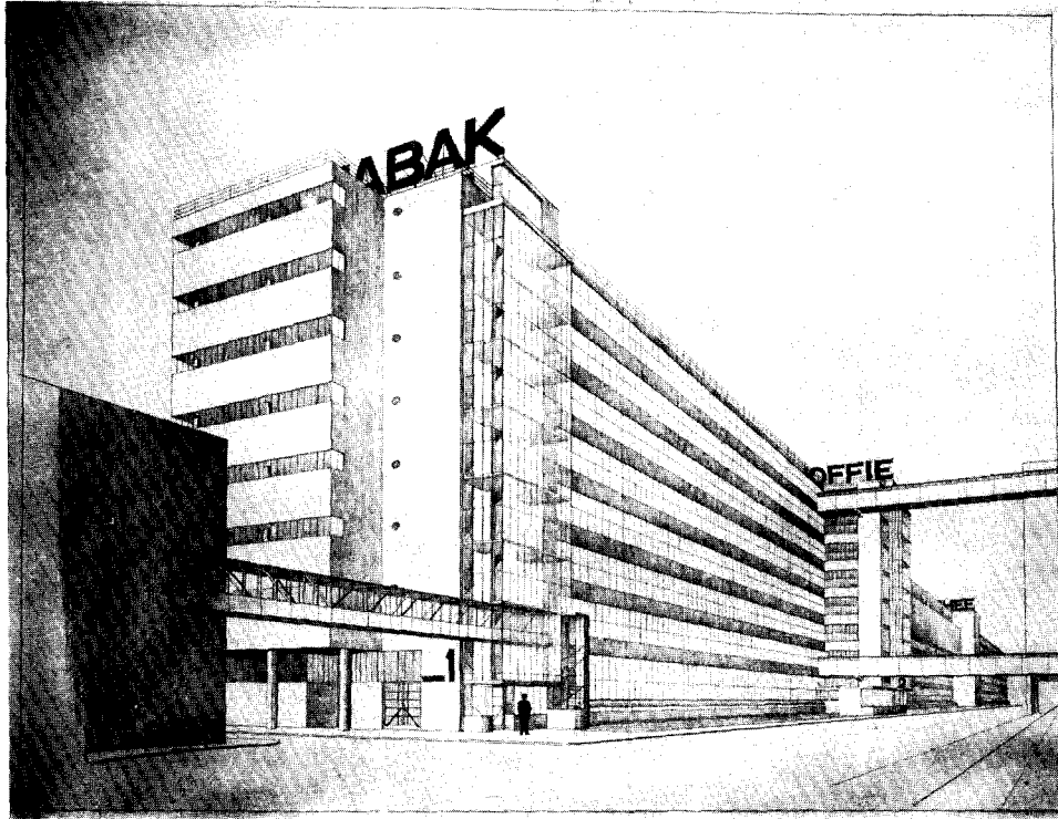
Afb. 10. Perspectieftekening van het ontwerp van de fabriek met hoge bruggen voor de transporteurs, vermoedelijk uit 1926; vergelijk afb. 11.
