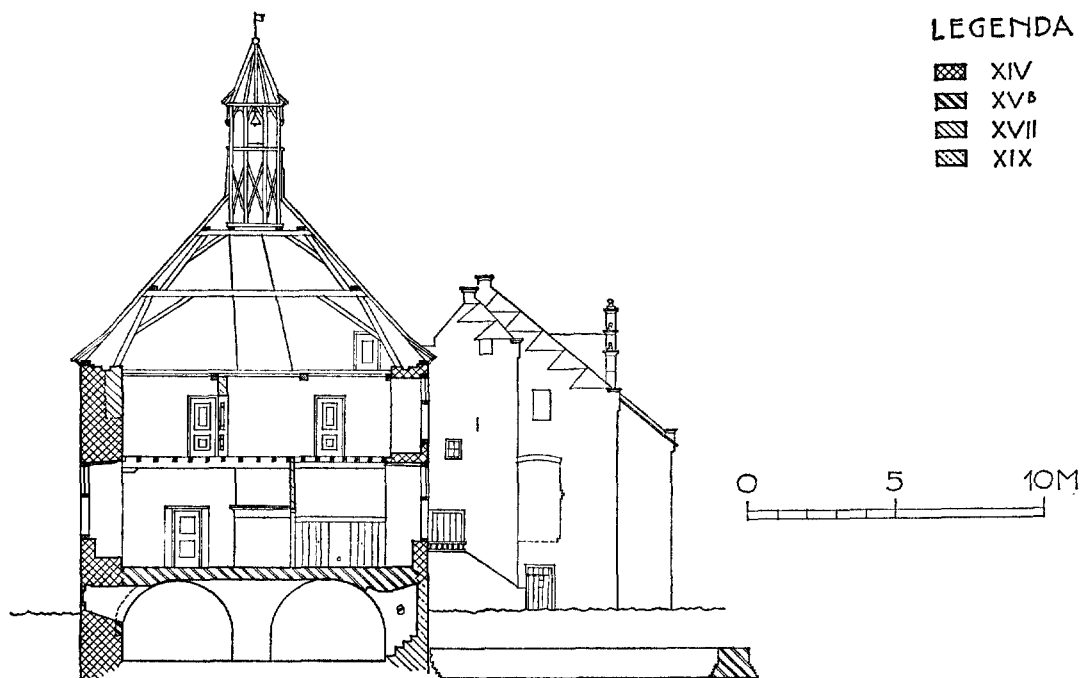
Fig. 4. Huis Doddendaal, dwarsdoorsnede EF, naar opmeting van Architectenbureau D. Wijma, Velp. (Tekening Monumentenzorg, H. W. van der Voet).
