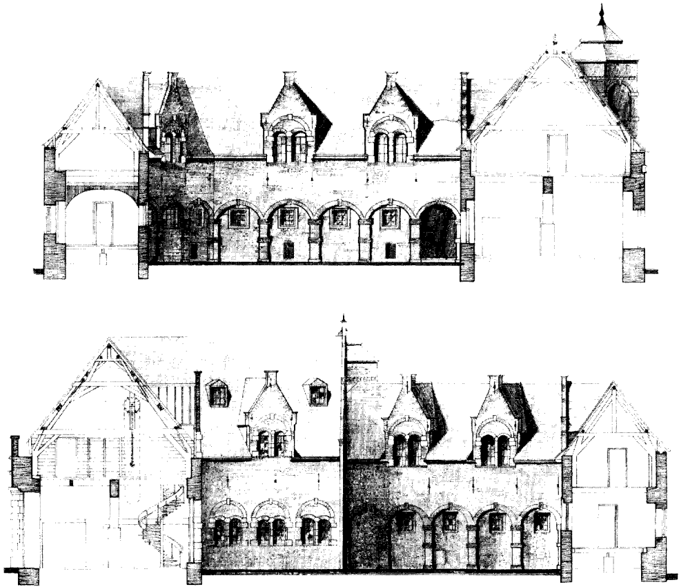
Afb. 2. Doorsnede Kruithuis smalle en brede vleugels na de restauratie, met gevels van de binnenplaats. (Tekening Gemeentewerken 's-Hertogenbosch 1975).
