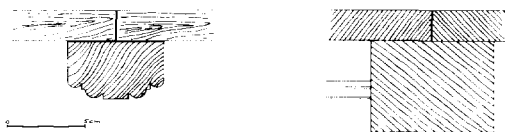
Afb. 8. Geprofileerde eiken kloesjes ter plaatse van de stuiknaden tussen de plafonddelen. Schaal 1:5.
