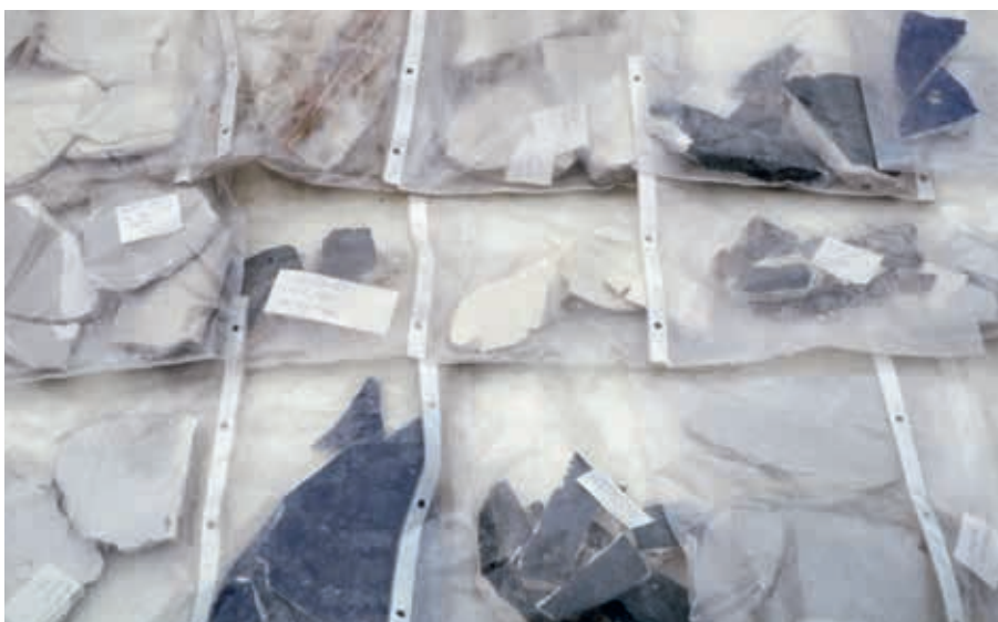
11. Monsters van stucwerk en kleur werden eerst verzameld en gesorteerd voor het kleuren-onderzoek; daarna zijn ze weggegooid (Bertus Mulder archief)
