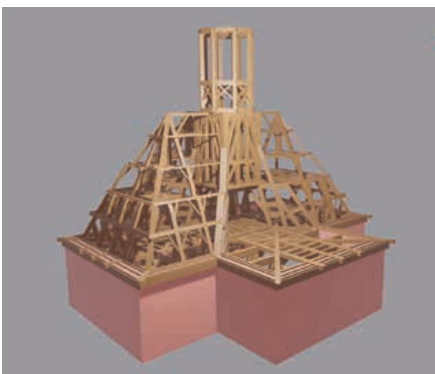
15C. De kappen van de vier kruisarmen zijn opgebouwd als traditionele, gestapelde dekbalkspanten
