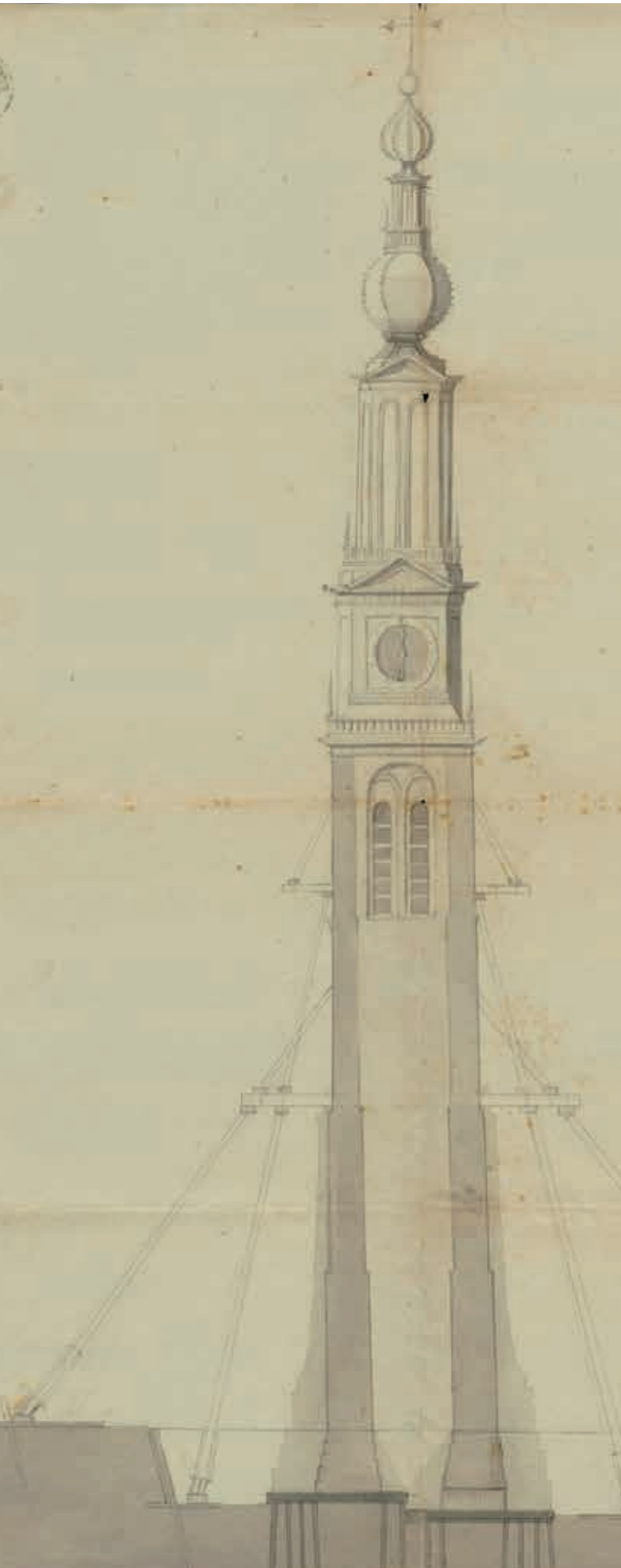
◀ 4. Sibout Bollard, ontwerp voor het stabiliseren van de toren van de Oude Kerk door middel van het opvijzelen van de ingekorte paalfundering en het ommetselen van het onderste deel van de toren, 1735 (Stadsarchief Amsterdam)
