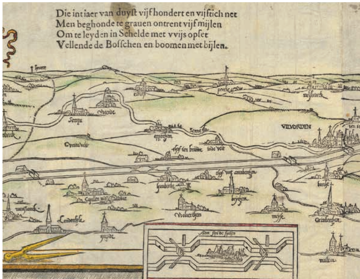
6. Anoniem, detail van de houtsnede van de Willebroekse Vaart met de nieuwe sluis van Humbeek (iets ten noorden van Vilvoorde), ca. 1565. De uitsnede onderaan laat zien dat de sluis twee paar puntdeuren had en suggereert dat in de kolk verschillende schepen tegelijk pasten (Universiteit Antwerpen)
