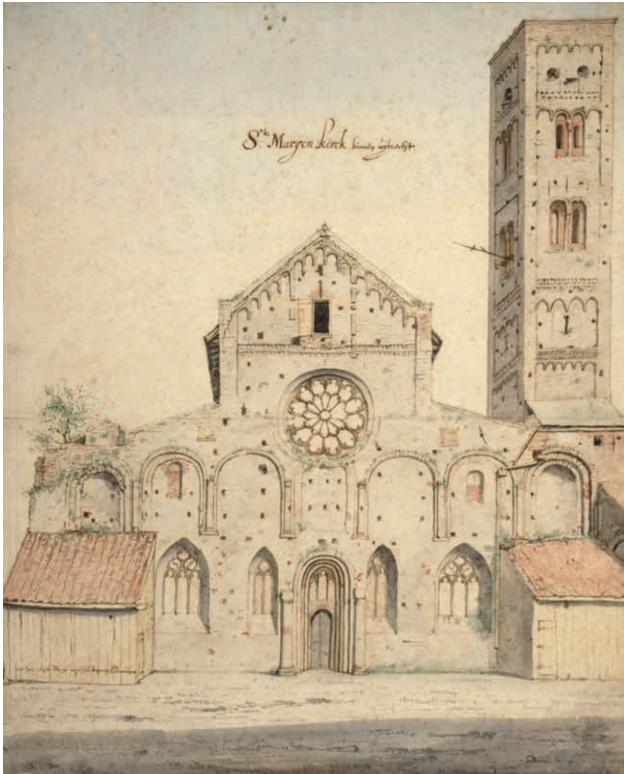
16. De Mariakerk van Utrecht van circa 1085, met rondboogfriezen in de westgevel. Tekening door Pieter Saenredam, 1636 (Het Utrechts Archief)
