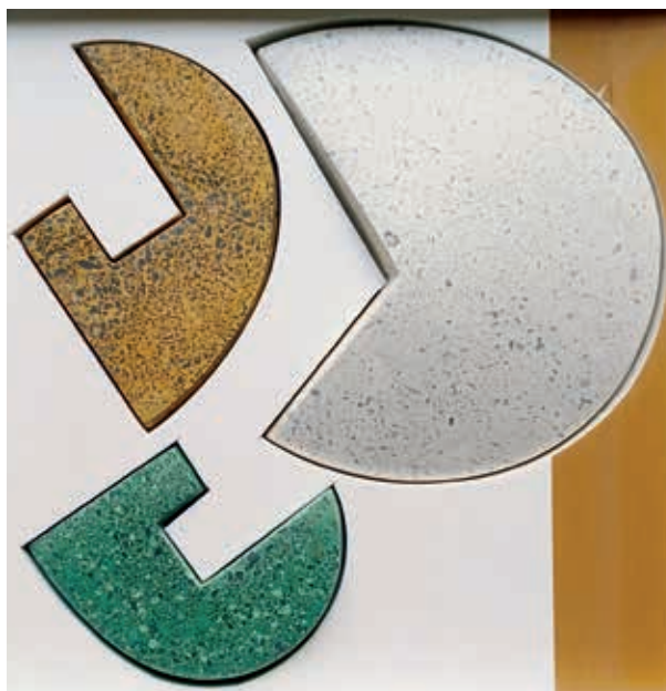
15. Overzicht van verschillende Inter-Beton-mixen speciaal ontwikkeld voor elk denkbaar gebruik. Stalen van MAR-mix in alle mogelijke vormen en kleuren (Archief betoncentrale Sint-Pieters-Leeuw, niet geïnventariseerd)
